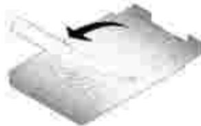
3. Abra la cubierta inferior de la bandeja de papel tomándola por los lados, tal y como se indica en la ilustración a continuación. No coloque los dedos debajo de la cubierta para abrirla.
