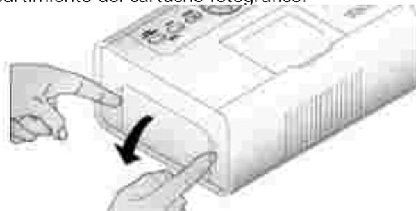
3. Inserte el cartucho con la etiqueta hacia arriba y la flecha apuntando hacia la impresora. Empuje el cartucho hacia adentro hasta que encaje.
